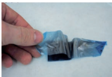
Tesafilm (Mitte) und überträgt es auf ein Substrat, so erhält man mit etwas Glück und Geschick einschichtiges Graphit –
