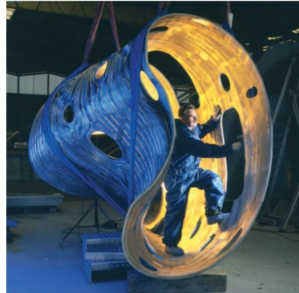
Zwanzig dieser Bauteile werden in den nächsten Jahren zum Plasmagefäß des Fusionsexperiments Wendelstein 7-X zusammengefügt. Die kompliziert geformten Spulen werden über das Plasmagefäß „gefädelt“. (Foto: IPP, W. Filser)
