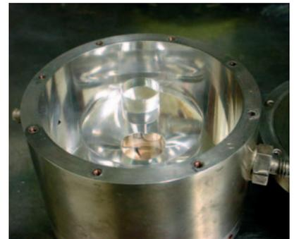
Die moderne Variante hat zylindrische kryogene Resonatoren aus Saphir, die ca. 2 cm im Durchmesser sind (rechts). (Foto: P. Wolf)
