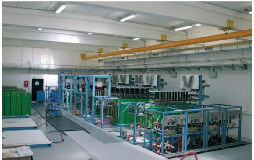
Ein Blick in die Halle des Hochfeldlabors Dresden. Hier wird die große Kondensatoranlage aufgebaut, welche die enorme Energie für die Magnetfeldspulen liefern soll. Um eine Feldstärke von 100 Tesla zu erreichen, sind 50 Megajoule nötig. (Foto: FZR)
