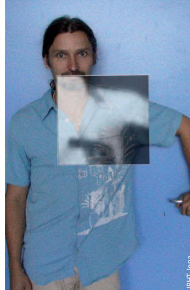
Terahertz-Strahlung durchdringt Kleidung und Papier und macht eine versteckte Pistolenattrappe sichtbar – die Sicherheitstechnik ist nur eine der denkbaren Anwendungen.
