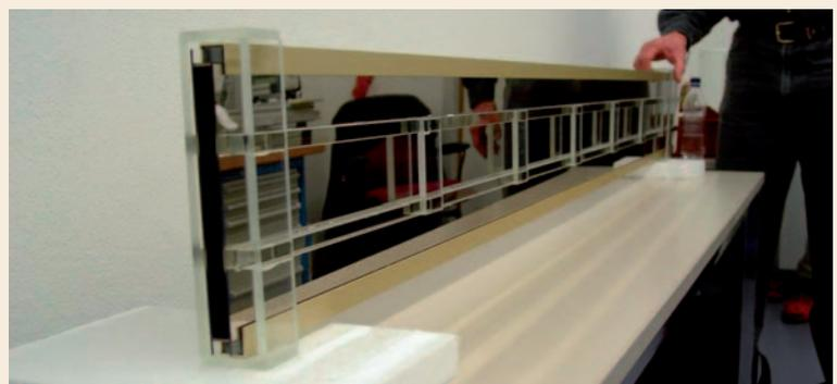
eigneten rechteckigen Leiterröhren zusammengeklebt werden. Bei Superspiegeln lässt sich dieser bescheidene Winkel der Totalreflexion durch einen Trick vergrößern. Auf das Glas werden alternierend Ni- und Ti-Schichten von einer solchen Dicke  $d$  aufgebracht, dass die Bragg-Beugung an diesem Multischichtsystem direkt an den Glanzwinkel  $\alpha_c$  anschließt (Abb.). Kontinuierlich variierende Schichtdicke  $d$  bedeutet Bragg-Reflexion über einen
