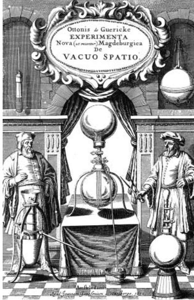
**Abb. 2:** Titelkupfer von Guericke's Hauptwerk aus dem Jahre 1672 mit der Barometerprobe (oben links), den Magdeburger Halbkugeln (oben rechts), einer Vakuumluftpumpe (unten links), kleinem und großem Rezipienten (unten rechts) und dem „hydraulisch-pneumatischen Gerät“ (Mitte)
