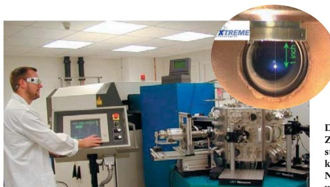
Das Licht der Zukunft? Chipstrukturen, die kleiner als 50 Nanometer sind, werden künftig voraussichtlich mit extrem ultravioletter Strahlung hergestellt. Erzeugen lässt sie sich z. B. in einem Strahl flüssigen Xenons, das durch einen starken Laser in den Plasmazustand übergeht. (Foto: XTREME technologies)
