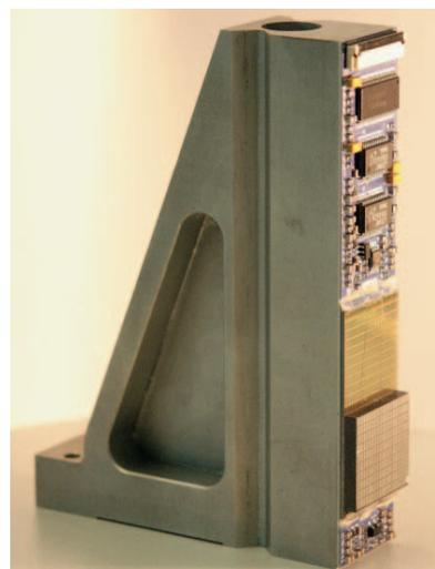
**Abb. 4:** Modul eines neu entwickelten Multiline-CT-Detektors mit integrierter Ausleseelektronik. Bei dem Modul sind deutlich die Pixelstrukturierung des oberen Detektors zu erkennen, der hier für Demonstrationszwecke noch nicht mit einem entsprechenden Szintillatorarray bedeckt ist.
