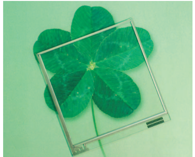
Dieses Touchpanel, welches z. B. in PDAs eingesetzt wird, ist nur 0,7 Millimeter dick. Der Rahmen, in dem sich die SAW-Elemente befinden, ist nur 1,4 Millimeter breit. (Quelle: Fujitsu)
