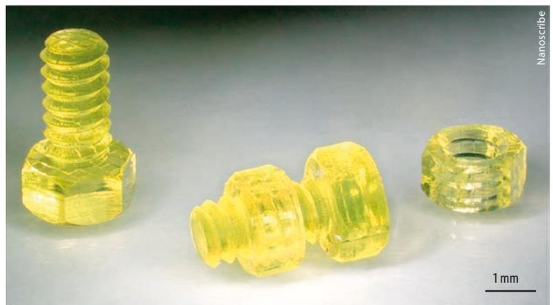
Auch größere Objekte wie diese Schrauben und Muttern mit etwa einem Millimeter Durchmesser lassen sich mit dreidimensionaler Laserlithographie erzeugen.
