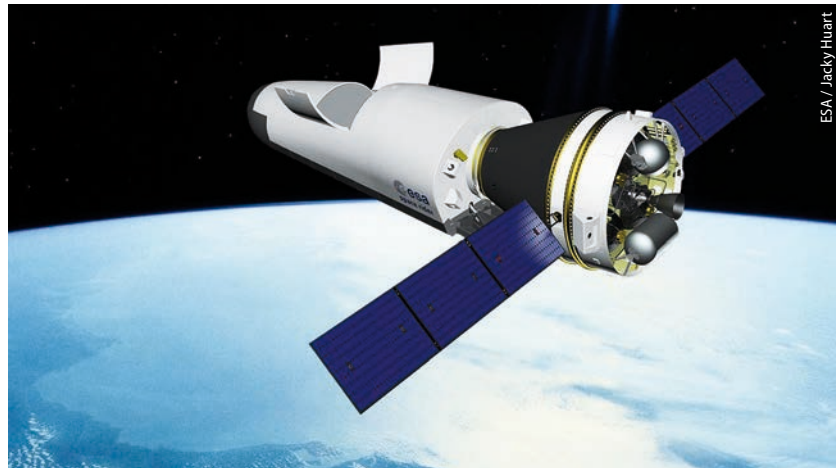
Mit dem neuen ESA-Budget soll der sogenannte Space Rider weiter entwickelt werden. Dabei handelt es sich um eine wiederverwendbare, unbemannte Raumfähre, die Forschung im Erdorbit ermöglichen soll.
