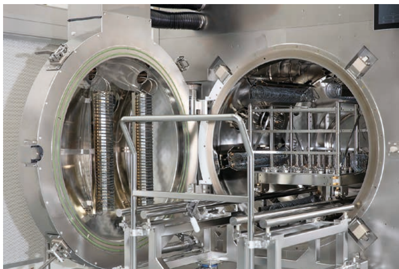
PINK betreibt in den Reinräumen unterschiedliche Vakuumöfen zum Ausheizen von Kleinteilen und Großteilen bis zu zwei Tonnen Gewicht. Eine optionale Plasmareinigung und ein Massenspektrometer zur Restgasanalyse sind ebenfalls integriert.
