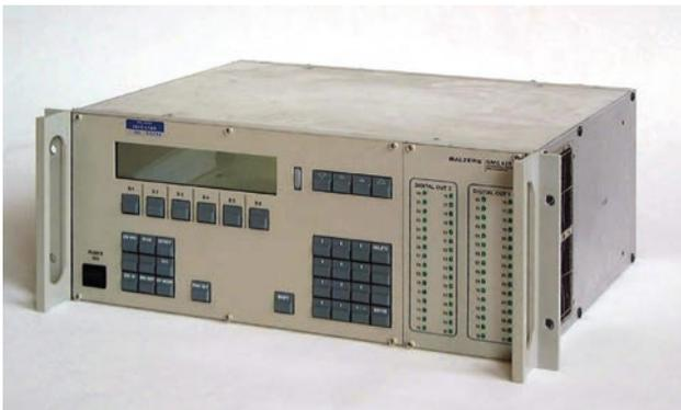
**Abb. 1** In den 1980er Jahren war das Steuergerät QMS 420 gebräuchlich, das in einem Rack eingebaut war.
