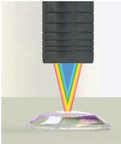
Abb. 1 Das konfokal-chromatische Messsystem, bestehend aus dem Sensor ConfocalDT IFS2405-3 und dem Controller ConfocalDT IFC2461, prüft die Mittendicke von dünnen optischen Linsen sowie deren Kontur bzw. Krümmung.
