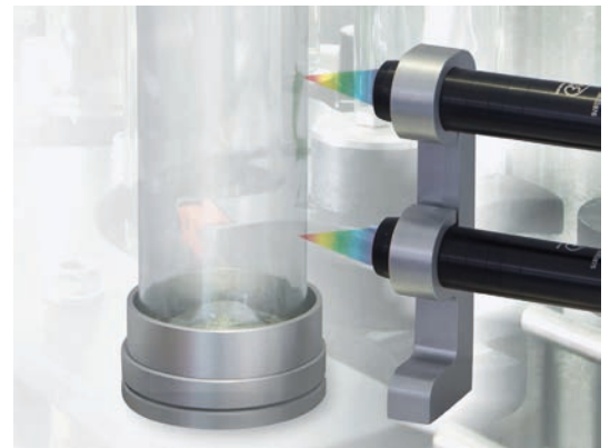
Abb. 2 Für den Prüfprozess werden die Flaschen rotierend an zwei konfokal-chromatischen Sensoren vorbeigeführt. Diese messen die Dicke der Flaschen an zwei Stellen synchron und mit einer Genauigkeit von 10 µm.
