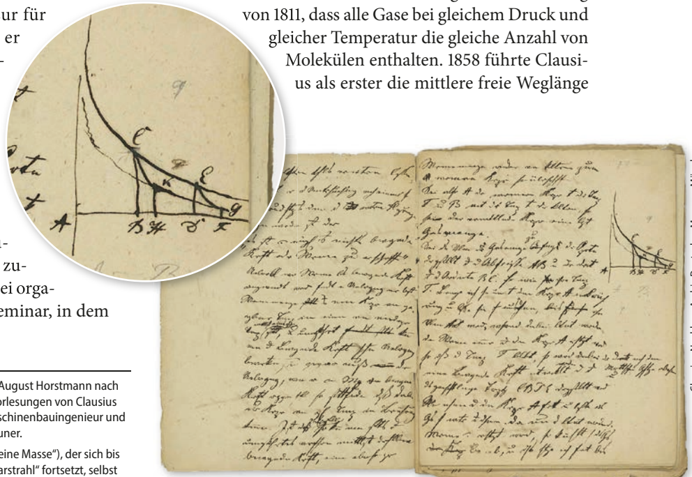
Abb. 2 Clausius' allererste Skizze des Carnot-Prozesses als p - V -Diagramm entstand 1844 für seinen Vortrag über Clapeyrons Arbeit im Kolloquium bei Magnus.
