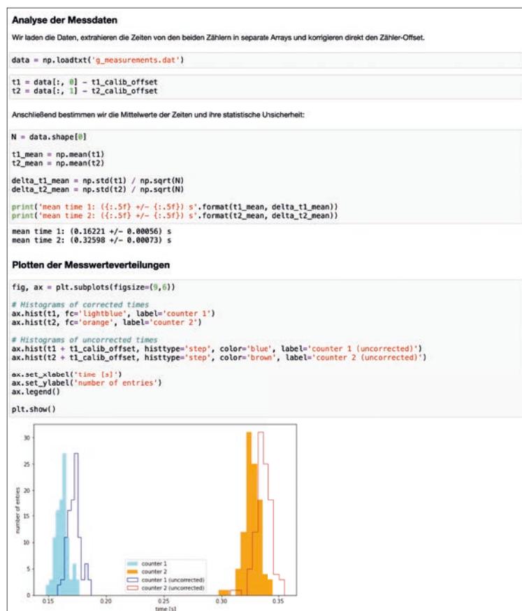
Abb. 1 Jupyter-Notebooks stellen Python-Code, Dokumentation und Grafiken auf einer Ebene dar, hier eine Analyse zur Bestimmung der Fallbeschleunigung.
