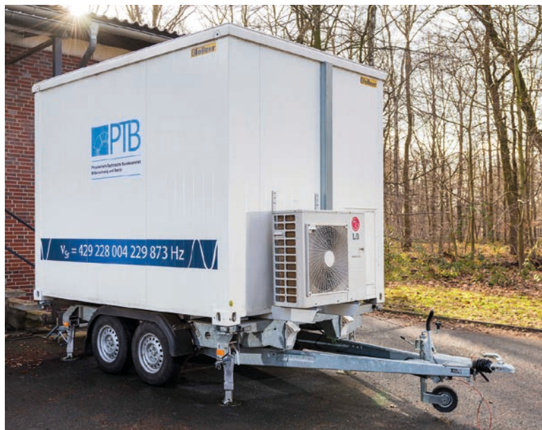
Abb. 5 In diesem Container befindet sich die transportable Sr-Gitteruhr.
