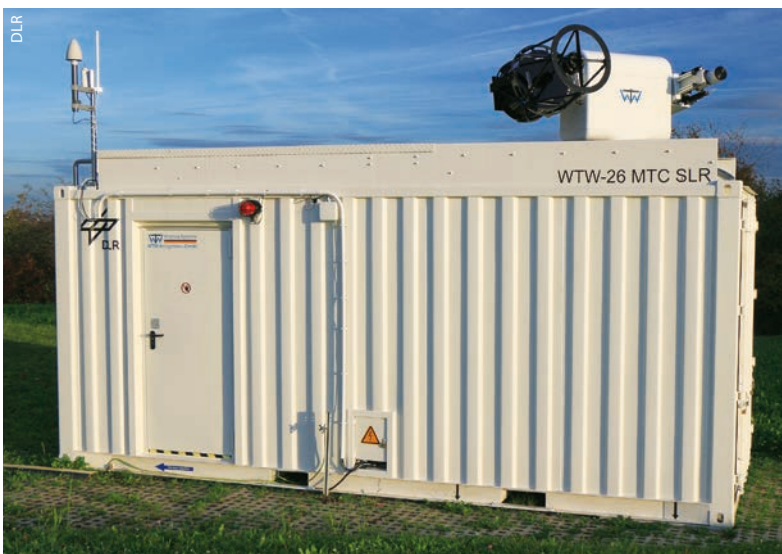
Abb. 6 Das transportable Laser-Ranging-System des DLR ist integriert in einen Standard ISO Container und wird derzeit auf den ersten Mess-Einsatz vorbereitet.
