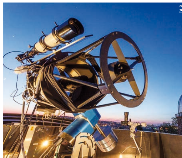
Abb. 4 Im Forschungsobservatorium Umlandshöhe werden Laserimpulse über den Refraktor (Sucherteleskop, oben) ausgesandt und vom Objekt zurückgestreute Photonen mit dem Spiegelteleskop (Mitte) detektiert.
