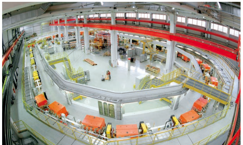
Der Speicherring COSY am Forschungszentrum Jülich lässt sich zur Messung der elektrischen Dipolmomente geladener Hadronen nutzen.
