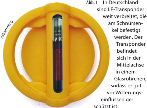
Abb. 1 In Deutschland sind LF-Transponder weit verbreitet, die am Schnürsenkel befestigt werden. Der Transponder befindet sich in der Mittelachse in einem Glasröhrchen, sodass er gut vor Witterungseinflüssen geschützt ist.
