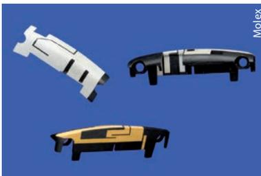
Mit Hilfe der Laser-Direkt-Strukturierung lassen sich Antennen direkt auf den Kunststoffträger aufbringen. Zu sehen sind LTE-Antennen, wie sie u. a. in Smartphones Verwendung finden.
