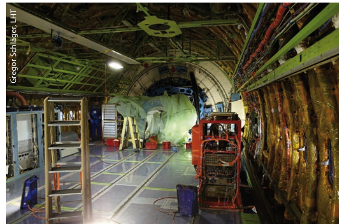
Im Rahmen der Inspektion wurde die komplette Kabineneinrichtung der Boeing 747-SP demontiert. Im Hintergrund ist das Teleskop zu erkennen (blau).
