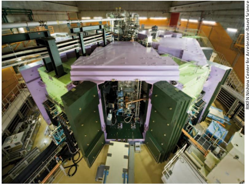
Abb. 1 Der Superconducting Ring Cyclotron an der Radioactive Isotope Beam Factory (RIBF) in Japan beschleunigt Primär-Teilchenstrahlen aus Zink-70-Ionen. Nach Fragmentation wurden
