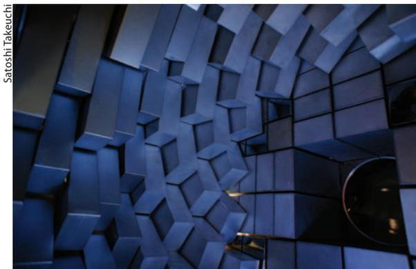
Abb. 2 Blick in den DALI2 Gamma-Ray Detector Array, mit dem die Anregungsenergie von Kalzium-54 gemessen wurde.
