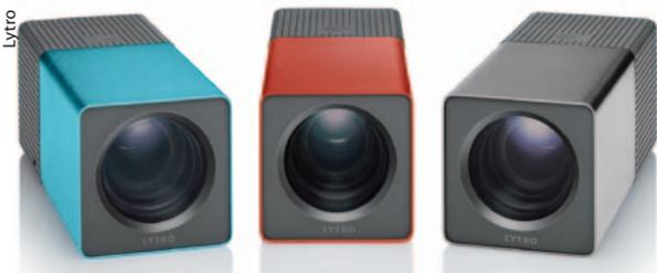
Die derzeit einzige Consumerkamera für die Lichtfeldfotografie erreicht eine Bildauflösung von 1080 mal 1080 Pixel. Sie hat eine feste Blende von 2 und ein optisches Zoomobjektiv mit der Kleinbild-Äquivalentbrennweite von 43 bis 344 mm. Das Ganze ist nicht billig – das günstigste Modell der Kamera kostet 480 Euro.
