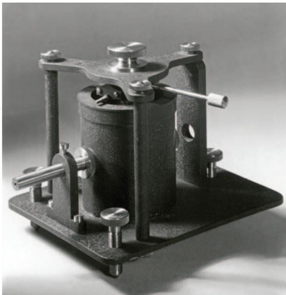
Abb. 5 Mit dieser eigens angefertigten Kamera untersuchten Peter Debye und Paul Scherrer u. a. Lithium-Fluorid-Pulver, das sich als besonders geeignetes Material erwies und besonders scharfe Linien zeigte.
