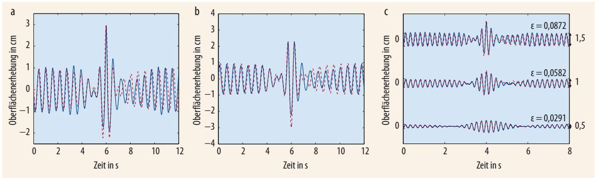
Abb. 5 Der Vergleich von im Wellenkanal erzeugten Peregrine-Breathern (blau) mit der theoretischen Erwartung gemäß NLS-Theorie (rot): Jeweils zum Zeitpunkt maximaler Amplitudenverstärkung können dabei ein extremer Wellenberg (a, „Kavents-
