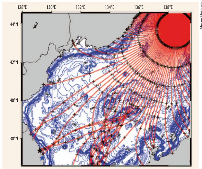
Abb. 2 Wellenausbreitung in einem Seegebiet mit Meeresströmungen und unterschiedlicher Tiefe (blaue Tiefenlinien). Die roten Strahlen sind dabei stets orthogonal zu den zugrunde liegenden Wellenfronten und wurden numerisch (mit Ray Tracing) bestimmt. Die Wellen breiten sich von rechts oben aus. Im unteren Bereich sind ausgeprägte räumliche Fokussierungseffekte erkennbar.
