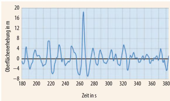
Abb. 1 Am 1. Januar 1995 wurde an der Offshore-Plattform Draupner in der nördlichen Nordsee eine plötzlich auftretende Riesenwelle registriert. Sie hatte eine Höhe von etwa 25 Metern in einem Seegang mit mittlerer Wellenhöhe von rund 8 Metern.
