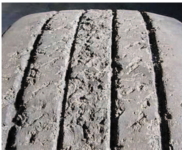
Abb. 1 Rauen Fahrbedingungen führen zu einem starken Verschleiß des Reifenprofils und können ein Abblättern („chipping“) und Ausbrechen („chunking“) der Lafoberfläche oder des Grundmaterials zur Folge haben.
