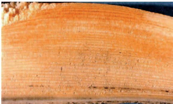
Abb. 5 Querschnitt eines im Godarville-Tunnel in Belgien von 1960 bis 1992 gewachsenen Stalagmiten. Man erkennt genau 32 Wachstumsschichten von etwa 1 mm Weite.
