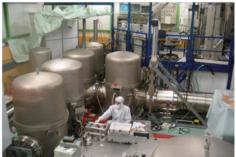
Abb. 2 Das Zentralgebäude von GEO600 – 20 km südlich von Hannover. Im Reinraum stehen die Vakuumtanks, in denen die optischen Komponenten des Detektors aufgehängt sind.
