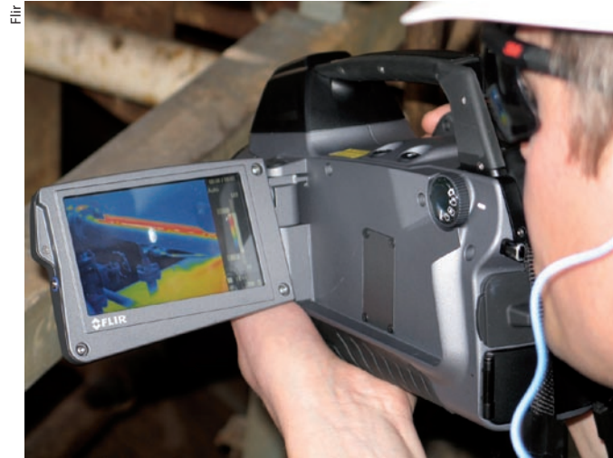
Abb. 2 Wärmebildkameras mit mikrobolometrischen Detektoren sind sehr handlich, da sie keine aufwändige Kühlung erfordern.
