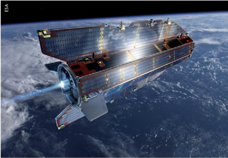
Abb. 2 Der Satellit GOCE umkreist die Erde auf einer sehr niedrigen, kreisförmigen Umlaufbahn von 254 km. Da in dieser Höhe noch die Atmosphäre spürbar ist, ist sein Rumpf aerodynamisch geformt.
