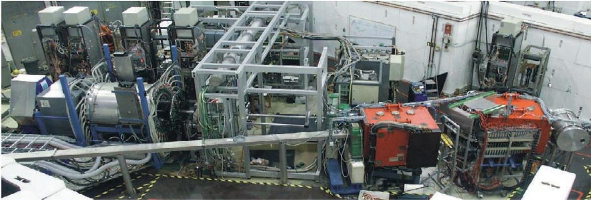
Abb. 4 Das Crystal Barrel/TAPS-Experiment am Elektronenbeschleuniger ELSA in Bonn [16], mit dem sich das Anregungsspektrum des Protons untersuchen lässt.
