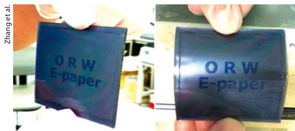
Dieses flexible optisch wiederbeschreibbare LCD ist für blaues Licht ausgelegt.
