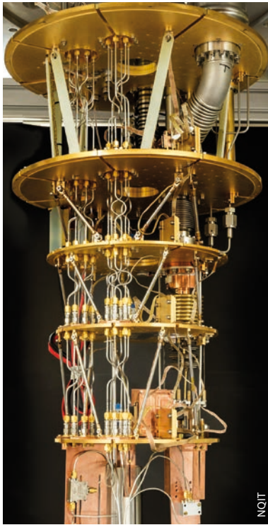
Supraleitende Qubits könnten die Basis von Quantencomputern werden.
