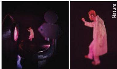
Projektor und projiziertes Bild eines volumetrischen Displays mit optischer Falle.
