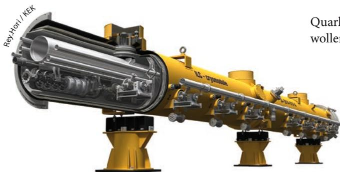
Supraleitende Kavitäten, eingebettet in ein Kryomodul, sollen beim International Linear Collider Elektronen und Positronen auf jeweils bis zu 125 GeV Energie beschleunigen.
