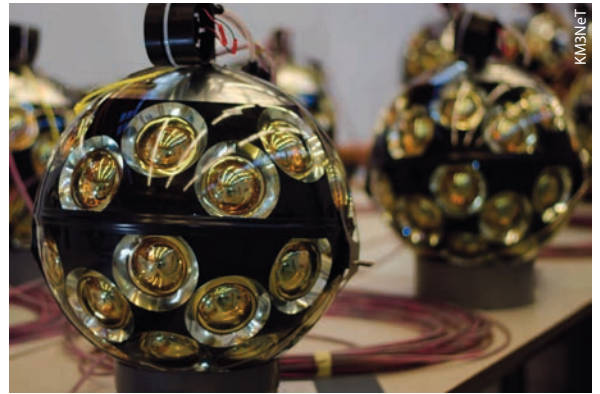
Die dreidimensionalen Detektorarrays, mit denen KM3NeT im Mittelmeer Neutrinos nachweisen soll, sind aus mehreren tausend dieser Module mit optischen Sensoren aufgebaut.
