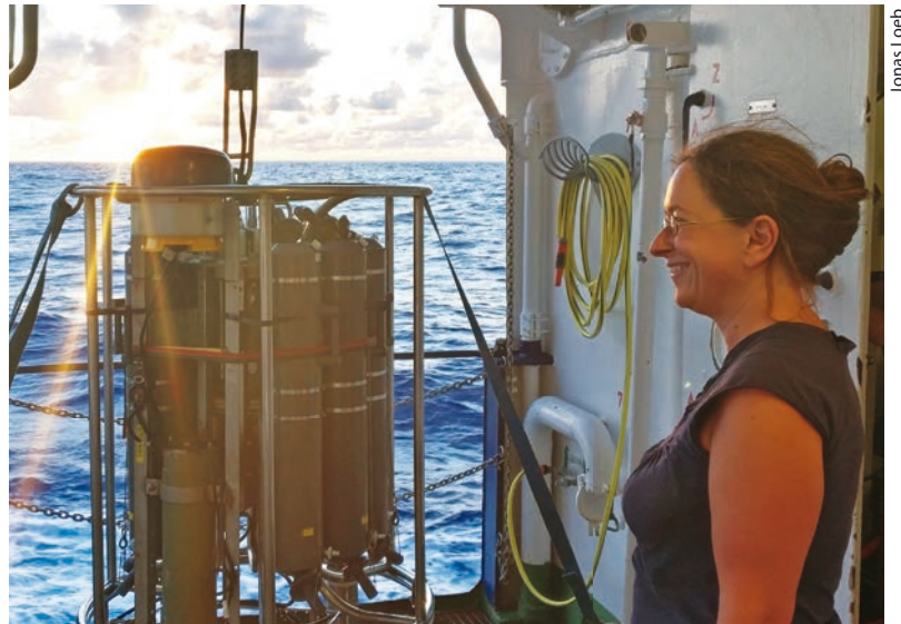
Maren Walter an Bord des Forschungsschiffs Poseidon mit dem CTD/Wasserschöpfer-System – CTD steht für Conductivity, Temperature, Depth Probe.
