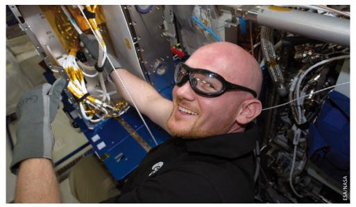
Alexander Gerst experimentiert mit dem elektromagnetischen Levitator – einer Art Schmelzofen, in dem metallische Proben freischwebend aufgeschmolzen und ohne störende Einflüsse und Wechselwirkungen untersucht werden.
