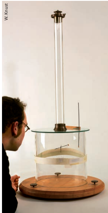
Der Nachbau einer Coulombschen Drehwaage ist wie das Original sehr empfindlich und störanfällig: Das Experimentieren erfordert viel Geschick.
