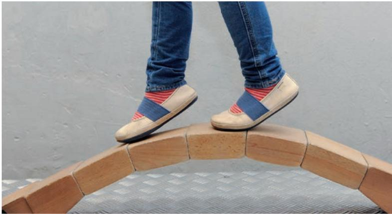
Wenn man diese Holzbrücke sorgfältig aus den einzelnen Teilen zusammengesetzt hat, trägt sie in der Mitte das Körpergewicht des erfolgreichen Experimentators.
