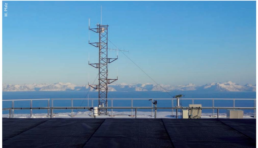
Auf dem Dach der Forschungsstation mit Blick auf die schneebedeckten Berge der Nachbarinsel. Wenn das RMR-Lidar misst, fährt die Decke zur Seite und gibt den Weg frei für die Laserstrahlen.
