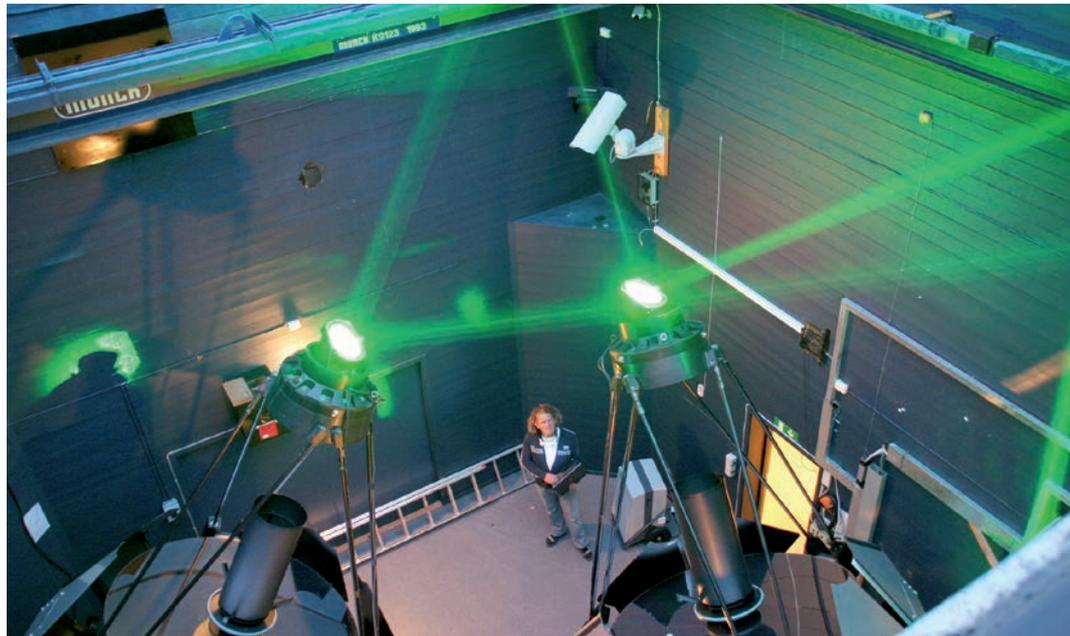
Gerd Baumgarten in der Teleskophalle. Die beiden Laser werden über die Primärspiegel entweder parallel zueinander oder um bis zu 30 Grad aus dem Zenit geschwenkt in die Atmosphäre geleitet.
