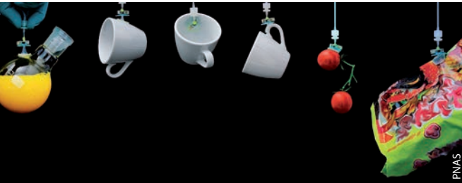
Der Vielzweckgreifer hält zuverlässig ein Glasgefäß, eine Tasse, Kirschtomaten oder eine Folienverpackung.
