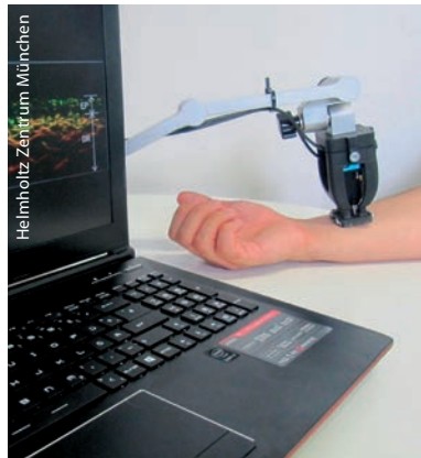
Der Gewebescanner bildet die Haut unter der Oberfläche ab.
