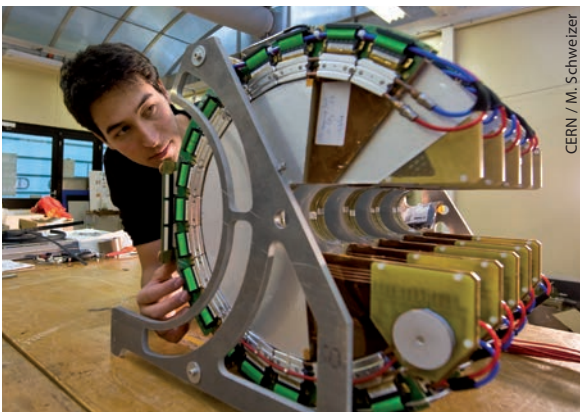
Zu den kleinen Experimenten am LHC gehört TOTEM, das den Kollisionspunkt des CMS-Experiments nutzt und unter anderem aus GEM-Detektoren besteht, die Teilchenspuren auch in der Nähe des Strahls bestimmen können.
