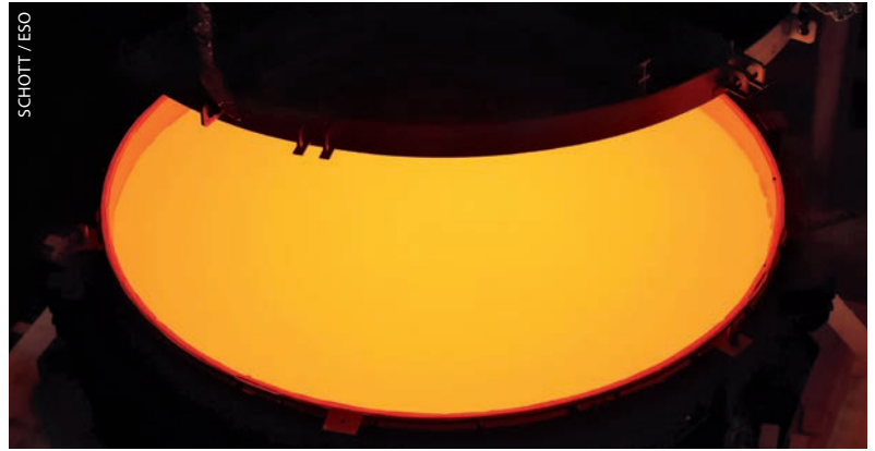
Beim Öffnen der Gussform ist der Rohling für den Sekundärspiegel des ELT noch glühend heiß – die Vorbereitung auf das Schleifen und Polieren dauert ein Jahr lang.
