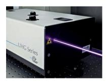
komplett neu entwickelt wurde. Innovative Antriebskonzepte erlauben nun sehr schnelles und dennoch zielgenaues Ändern der Wellenlänge und neue optische Konzepte bringen teilweise drastische Verbesserungen insbesondere für den kompletten UV-Bereich.
