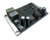
Unter maßgeblicher Beteiligung der Baden-Badener Ingenieure entstand das Multi-Kanal Treibersystem LASY18A-12C zum Treiben von Pumpdioden von Faserlasern. Der wassergekühlte 3 HE-Einschub nimmt Module für 6, 9 oder 12 Kanäle auf. Von 5 kHz bis DC können pro Kanal auch mehrere Dioden bei max. 18 A bis zu 50 V in Serie betrieben werden
