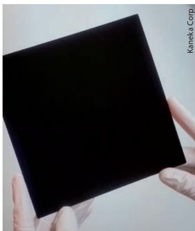
Japanische Forscher haben diesen besonders leistungsfähigen Prototyp einer Siliziumsolarzelle hergestellt.
