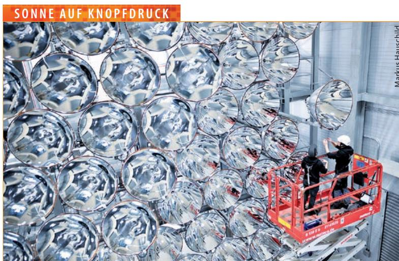
Seit Ende März scheint in Jülich die größte künstliche Sonne der Welt. In der Synlight-Forschungsanlage strahlen dazu 149 Xenon-Kurzbogenlampen, die sich auf eine Fläche von 20 mal 20 Zentimeter fokussieren lassen. Trifft die Strahlung der Lampen mit einer Leistung von bis zu 350 Kilowatt dort auf, hat sie die bis zu 10 000-fache Intensität der Solarstrahlung auf der Erde. Im Fokus der Lampen entstehen Temperaturen bis zu 3000 °C. Das reicht aus, um Treibstoffe wie Wasserstoff herzustellen.
