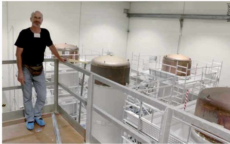
Stefan Jorda in der Laserhalle von VIRGO – in den Vakuumbehältern mit den dunklen Deckeln befinden sich die „Superdämpfer“ mit den Spiegeln und dem Strahlteiler.
