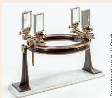
Interferometer von Ludwig Mach
